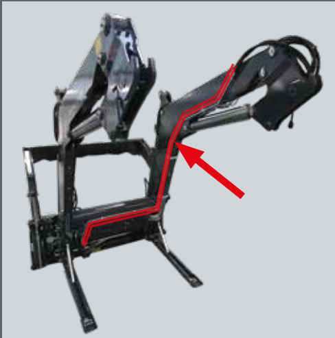
Montarea țevelor pentru REAL3 rd
